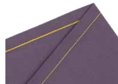
Point de chaînette couture d'assemblage ou décorative – très solide
