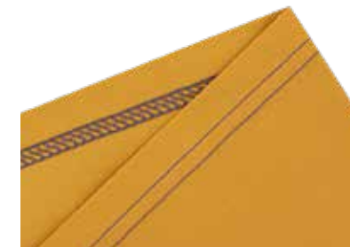
Point de recouvrement 3 fils pour tous types de finitions d'ourlets
