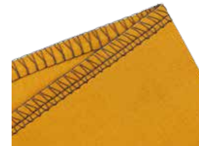
Surjet à 3 fils surfilage de bords de tissus ouverts
