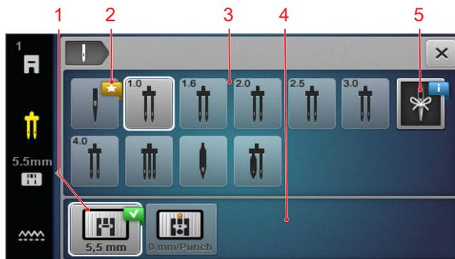
**1** Plaque à aiguille sélectionnée **2** Nous recommandons **3** Table récapitulative des aiguilles **4** Vue d'ensemble des plaques à aiguille **5** Note sur l'aiguille
