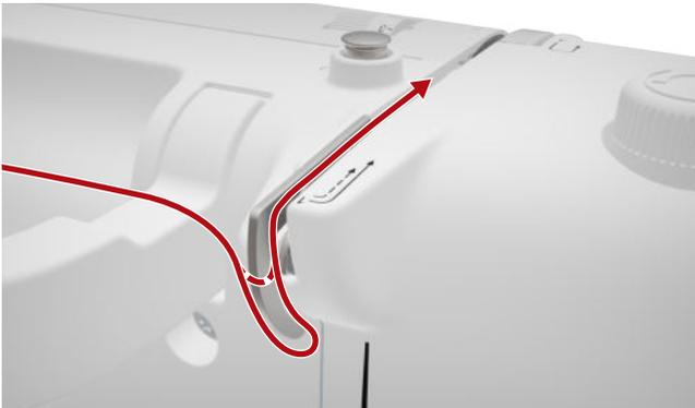
10. Guider le fil vers le bas en passant à droite du disque de tension du fil.
