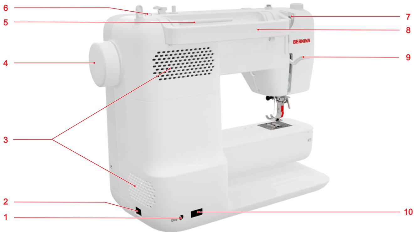
**1** Prise pour pédale **2** Interrupteur principal **3** Fentes d'aération **4** Volant **5** Support de bobine de fil, horizontal
