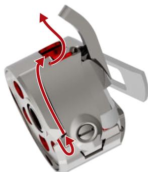
10. Mettre en place le boîtier de canette. Ce faisant, maintenir le boîtier de canette par la languette de sorte que le guide-fil soit orienté vers le haut.
