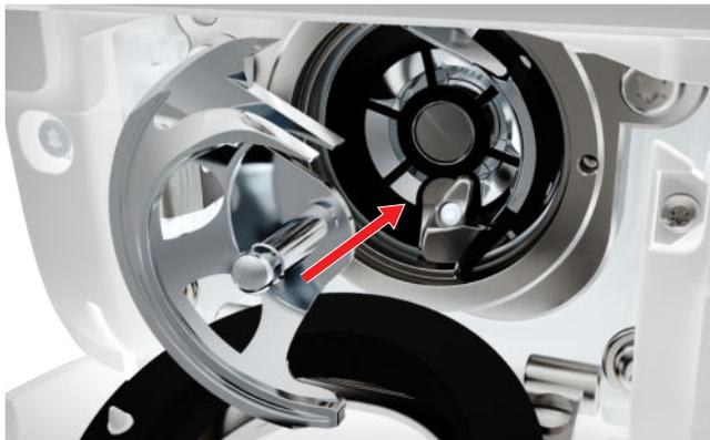
8. Insérer le crochet, si nécessaire, tourner le volant jusqu'à ce que le chasse-navette soit à gauche.
