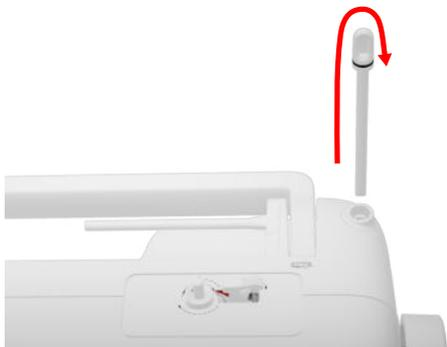
3. Monter un disque en mousse et la bobine de fil sur le support de bobine vertical.
