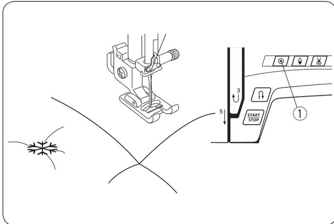
Vous pouvez retenir les épaisseurs de matelassage et le rembourrage en utilisant le point d'attache. Sélectionnez le point d'attache. Appuyez sur la touche d'arrêt automatique. Commencez à coudre. La machine coud le point d'attache et le point d'arrêt puis s'arrête automatiquement.
