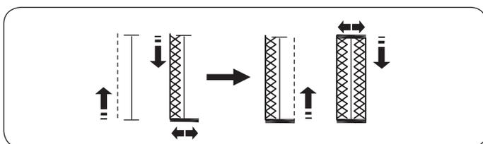
La machine coud la bride d'arrêt de devant et la colonne de gauche d'abord.
