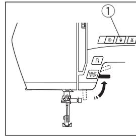
Relevez le pied-de-biche. Appuyez sur la touche position d'aiguille haute/basse ① pour relever le levier de fil au maximum.
