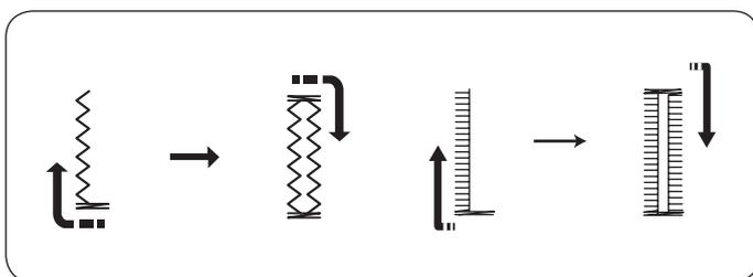
La machine coud la bride d'arrêt de devant et la colonne de gauche d'abord.
