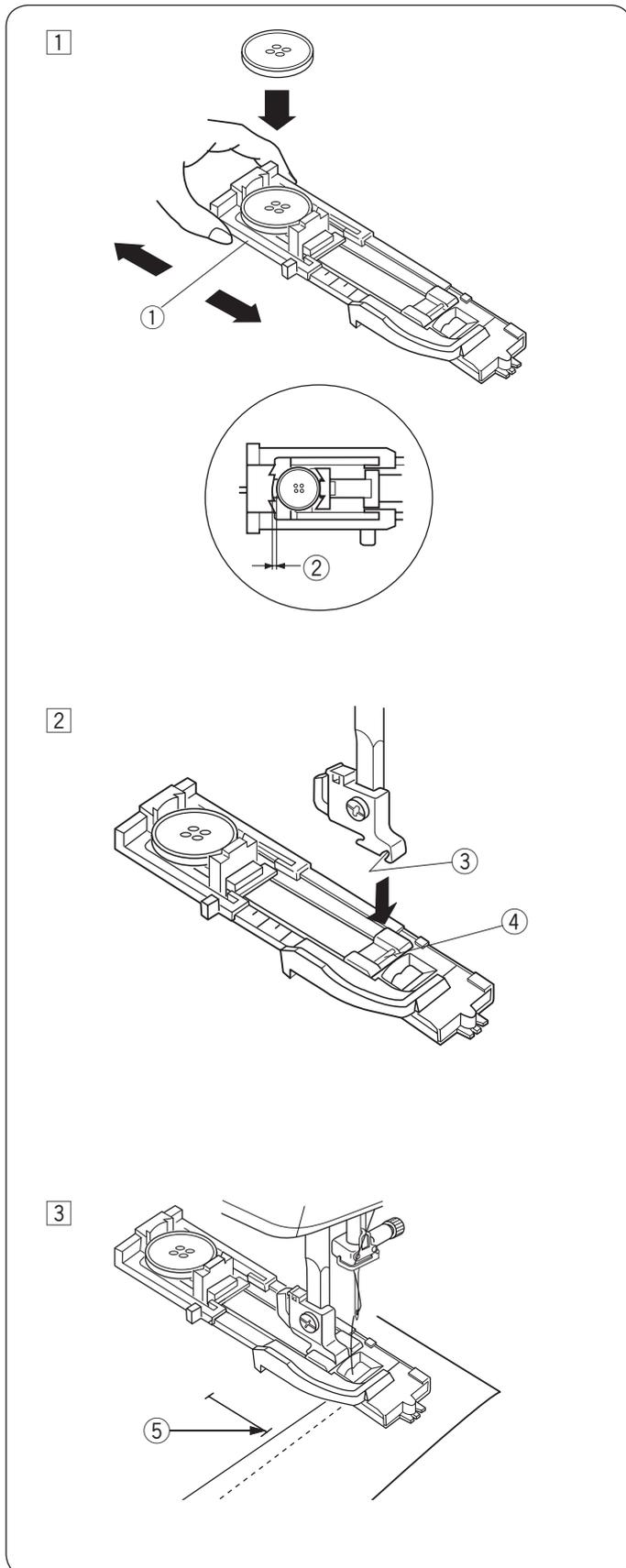
La dimension de la boutonnière est automatiquement réglée lorsque vous placez le bouton à l'arrière du pied pour boutonnière automatique R. Le porte-bouton du pied accepte des boutons de 1 à 2,5 cm de diamètre. L'écran LCD vous recommande d'abaisser le levier sensor pour boutonnière au moment de sélectionner les boutonnières avec détecteur.
