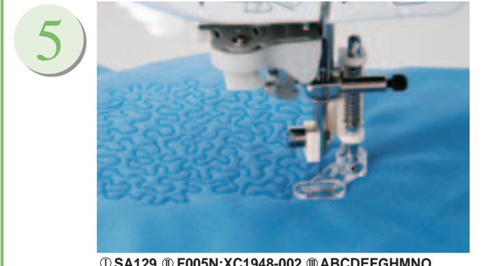
5 ① SA129 ① F005N:XC1948-002 ② ABCDEFGHMNO ① SA165 ① F040N:XC1972-002 ② L Quilting Foot - Spring action foot for darning, quilting or free-motion embroidery Pied transparent pour ouatnage/matelassage - Pour réaliser des surpiques parfaites (couette, coussin,...) Quilt-und Stickfuß - Zum Quilten und freien Sticken und Stopfen Quilt-en wattervoet - Voor vrij quilten Prensatela de acolchado - Prensatela efecto ola para zurcido, acolchado o libre bordado Piedino per trapunte - Piedino a pressione per rammendare, per quilting o per ricami a mano libera Лапка для квилтинга - для штопки, выстигивания или вышивания со свободной подачей материала
